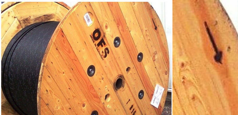
Abbildung 15 Abrollrichtung der Trommel beim Einziehen oder Einblasen
